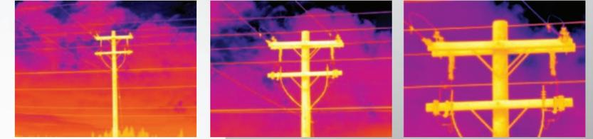
Standard (à gauche), téléobjectif 2x (au centre) et téléobjectif 4x (à droite)—observez le niveau adéquat de détails infrarouges essentiels
