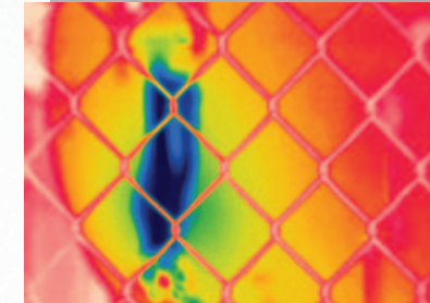
パッシブ・オート・フォーカス・システムでは、近景の被写体 (フェンス) のみが捉えられている
