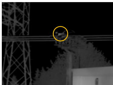
图 5：使用福禄克 2 倍长焦镜头扫描相同区域发现开关上存在一个明显的热点。
