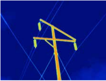
图 7: 使用 TiX560 热像仪和标准镜头捕获的高压输电杆。
