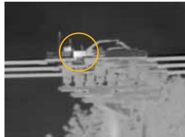
Figura 6. Esta tercera imagen de la línea de transmisión de la subestación, capturada con una lente teleobjetivo 4x de Fluke, muestra con claridad un punto caliente o de alta resistencia en un conmutador de palanca.
