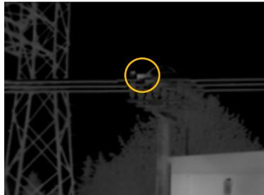
Figura 5. Al analizar la misma zona con una lente teleobjetivo 2x de Fluke, es posible observar un punto caliente definido en el conmutador.
