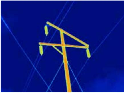
Figura 7: Poste eléctrico de alta tensión, captado con una cámara TiX560 y una lente estándar.
