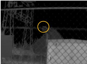
Figura 4. El análisis externo de un equipo exterior en una subestación con una cámara termográfica TiX560 y una lente estándar captó una anomalía en uno de los conmutadores de fase.
