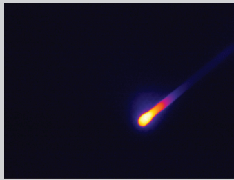
Abbildung 4: Dieses Bild eines Streichholzes unmittelbar nach dem Erlöschen wurde mit einer Wärmebildkamera TiX560 und einem Standardobjektiv aufgenommen.
