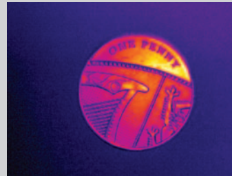
Figura 6. La foto di questo penny, di circa 20,3 mm di diametro, è stata scattata con una termocamera TiX560 e un obiettivo standard.
