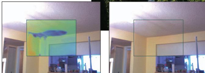
Mit dem Bild-in-Bild-Modus der IR-Fusion®-Funktion wird sonst unsichtbare Feuchtigkeit sofort erkennbar und auf der Gebäudewand abgebildet.
