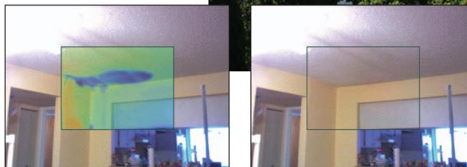
De otro modo, la humedad invisible es fácil de ver y localizar con una cámara termográfica en la pared usando el modo “picture-in-picture” de la tecnología IR Fusion®.
