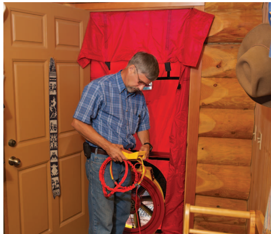
Abbildung 6: Aufstellen eines Blower-Door-Geräts.
