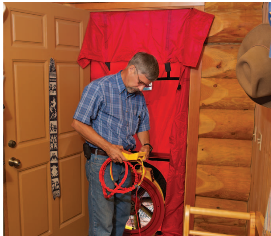
Figura 6. Instalación del dispositivo de prueba de estanqueidad en puertas.
