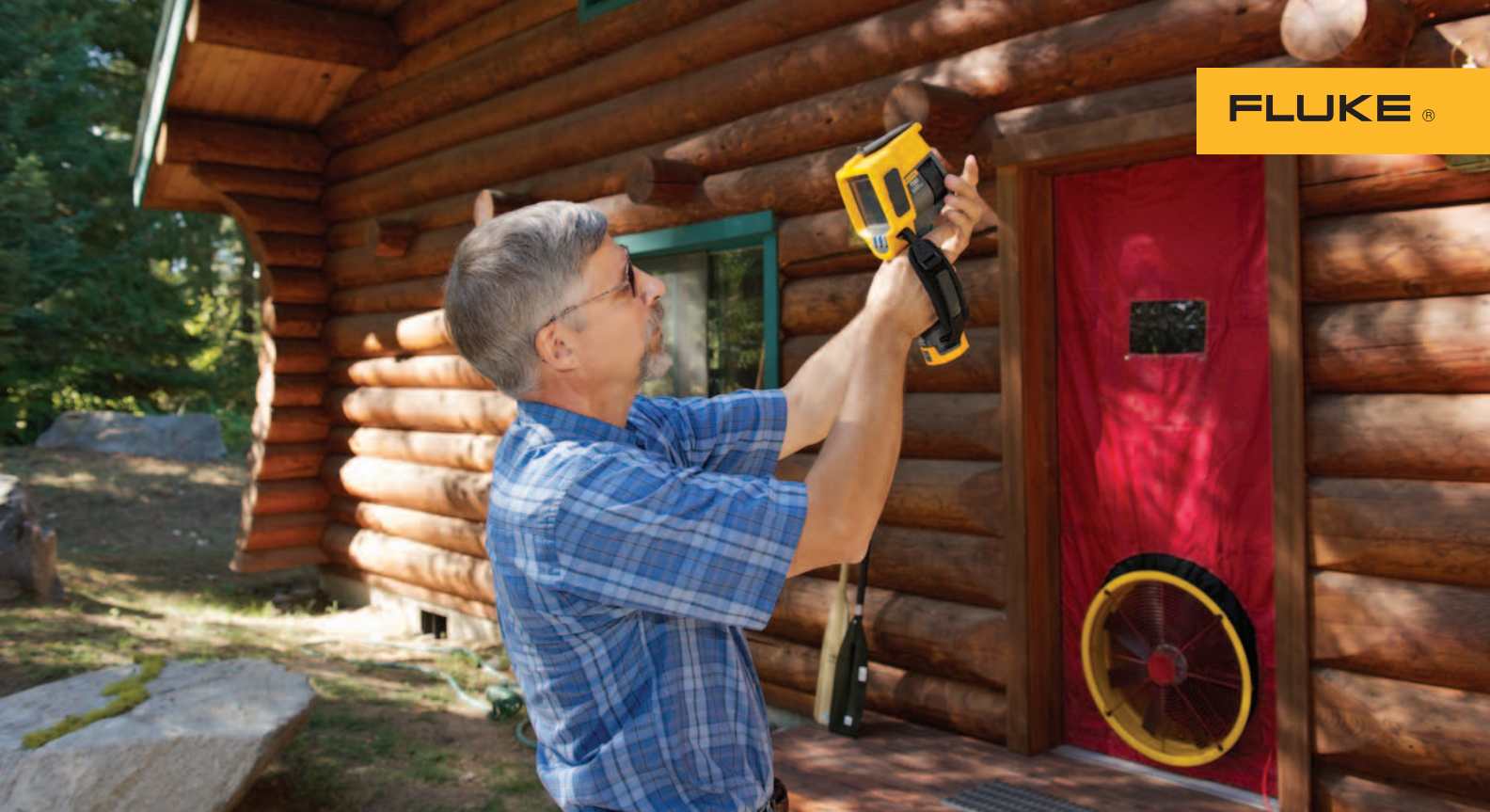
Figura 7. Utilizzo di una termocamera con blower door installata temporaneamente, per cercare le fughe di aria. È importante comprendere l'impatto dell'irradiazione solare.
