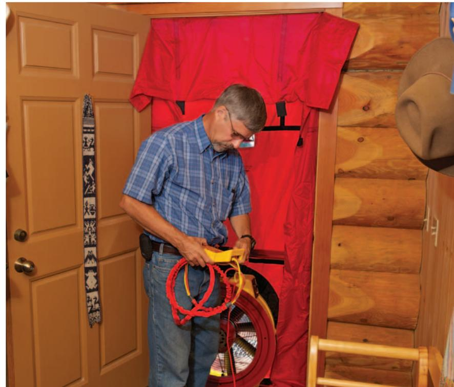
Figure 6. Mise en place du dispositif d'infiltrométrie.
