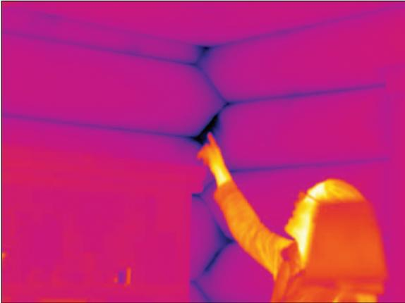
Figure 5. Le propriétaire souligne l'infiltration d'air froid.
