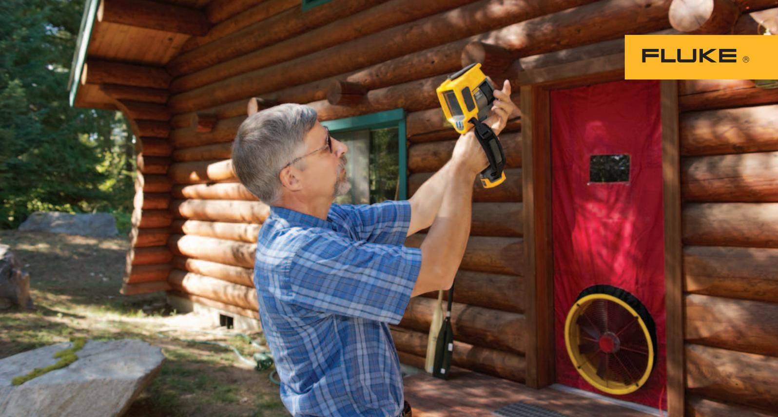
**Figure 7.** L'utilisation d'une caméra thermique avec infiltrométrie installée temporairement, pour rechercher l'exfiltration de l'air. Soyez conscient de bien comprendre l'impact de la charge solaire.
