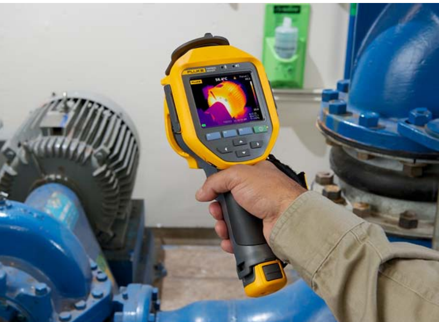
Acquisire un'immagine di base di tutti i motori da confrontare nel corso del tempo, e quindi ricercare sistematicamente punti caldi anomali sul motore, a pieno carico.
