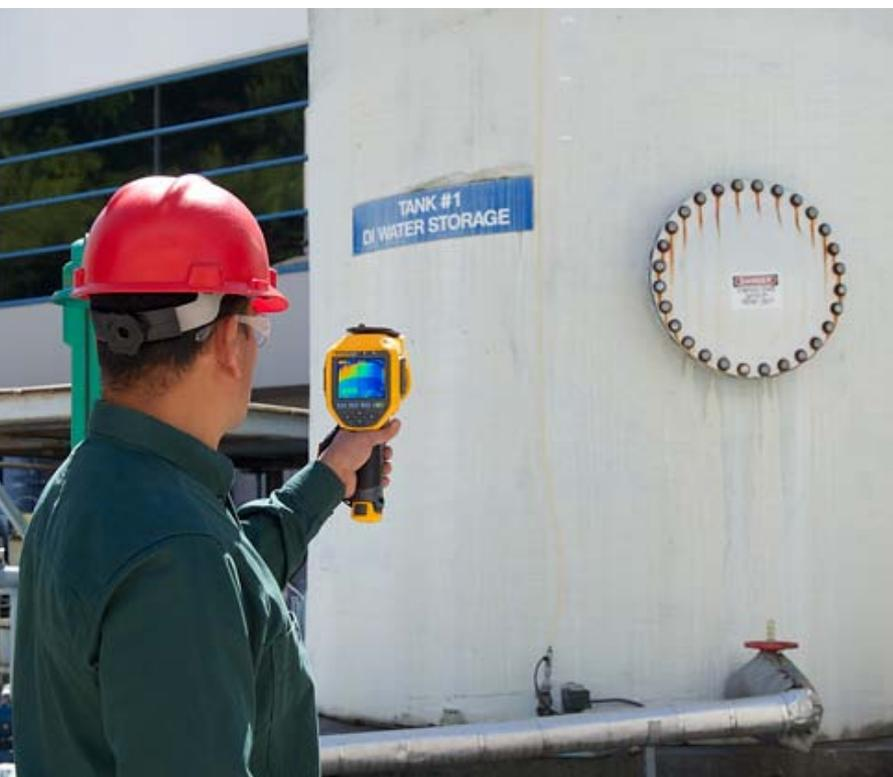
Le termocamere sono in grado di rilevare il livello del liquido o di altre sostanze all'interno di un serbatoio, purché vi sia differenza di temperatura tra il liquido, l'aria all'interno e l'aria all'esterno, e che il serbatoio non sia in materiale lucido.
