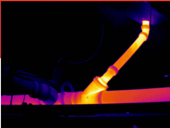
Le immagini a infrarossi mostrano un blocco parziale di una linea di scarico dei rifiuti liquidi del processo. Il mancato riconoscimento del deterioramento potrebbe provocare gravi problemi.
