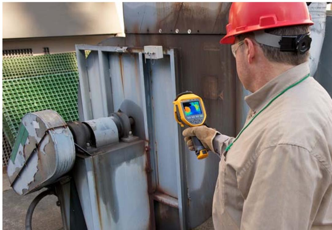
La misurazione di alberi in acciaio inossidabile lucido con le termocamere può risultare difficile. Compensare effettuando la misurazione vicino ai raccordi.
