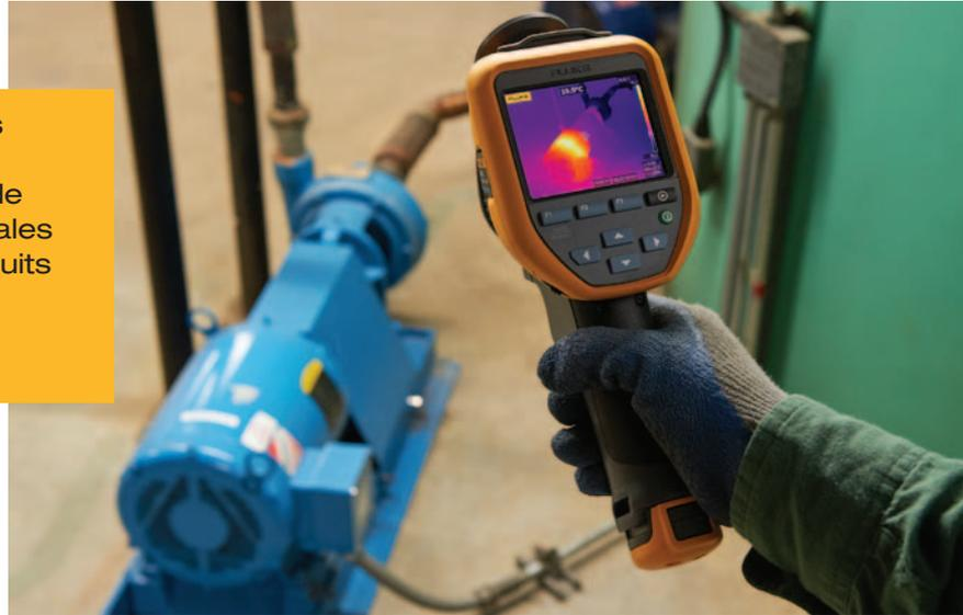
les pompes et les ventilateurs, d'élaborer les profils de boîtiers, d'analyser les roulements et les joints, ainsi que les accouplements d'arbres, les courroies de transmission et les poulies. Quant aux compresseurs, utilisez plusieurs images si nécessaire, afin d'établir le profil complet de toute l'unité.
