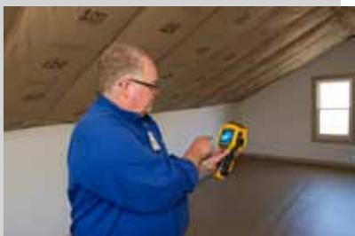
**Inspeccione rápidamente en busca de fallos o daños en el aislamiento.**
