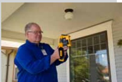
El exclusivo autofocus LaserSharp® usa un medidor láser de distancia incorporado que calcula la distancia hasta el objeto deseado con la máxima precisión.
