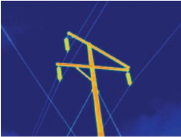
Abbildung 1: Ein Bild von einem Hochspannungsmast, das mit einer Wärmebildkamera TiX560 mit Standardobjektiv aufgenommen wurde.
