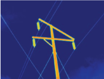
Figura 1: Polo de alimentación de alta tensión capturado con una cámara TiX560 y una lente estándar.
