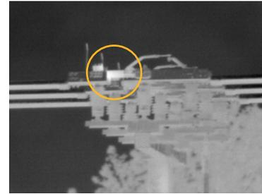
Figure 6. Cette troisième image de la ligne de transmission du poste électrique, capturée avec un téléobjectif Fluke 4x, montre clairement un point chaud ou une résistance élevée sur un interrupteur à couteau.
