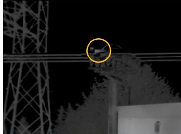
Figure 5. En inspectant la même zone avec un téléobjectif Fluke 2x, on voit clairement la présence d'un point chaud sur l'inverseur.
