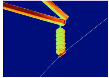
Figure 9 : le point de connexion droit capturé depuis la même distance que pour la Figure 7, mais avec un téléobjectif Fluke 4x. Le téléobjectif 4x vous offre le niveau de détail nécessaire pour vérifier si vous êtes confronté à un problème potentiel ou s'il s'agit simplement d'un reflet, comme c'est le cas ici.
