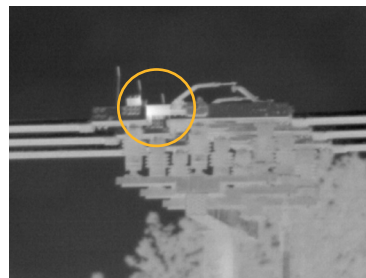
Figura 6: Esta terceira imagem da linha de transmissão da subestação, capturada com uma lente de telefoto 4x da Fluke mostra claramente um ponto de calor ou alta resistência em uma chave faca.
