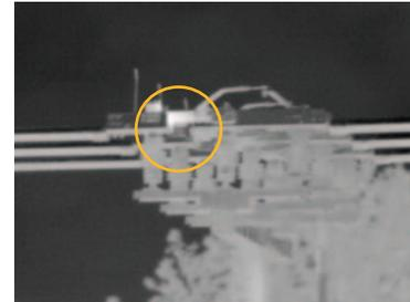
Abbildung 6: Dieses dritte Bild der Übertragungsleitung des Umspannwerks, das mit einem 4-fach-Teleobjektiv von Fluke aufgenommen wurde, zeigt eindeutig einen Hot-Spot oder einen hohen Widerstand an einem Messerschalter.
