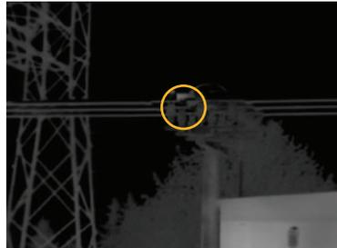
Abbildung 5: Die Abtastung desselben Bereichs mit einem 2-fach-Teleobjektiv von Fluke zeigt definitiv einen Hot-Spot am Schalter.
