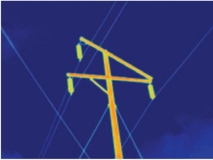
Abbildung 7: Ein Bild von einem Hochspannungsmast, das mit einer Wärmebildkamera TiX560 und einem Standardobjektiv aufgenommen wurde
