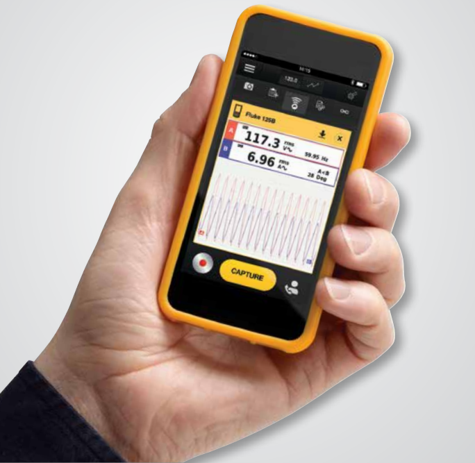
快速地逐步顯示記錄事件，以辨識和進行疑難排解間歇性故障。
