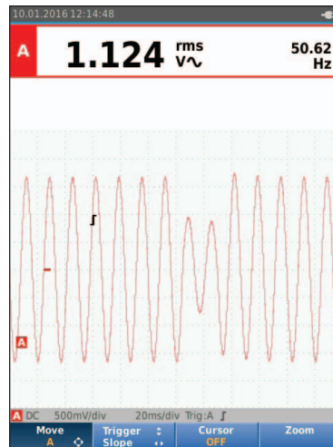
Triggerpunkten är inställd på en punkt, men på grund av avvikelserna på den andra periodens ledande flank resulterar en ytterligare trigger i en instabil visning.
