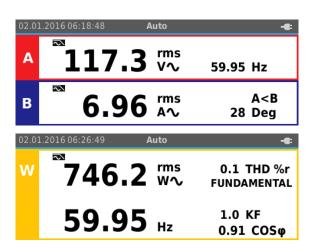
Dapatkan karakteristik daya yang penting dengan mudah untuk memvalidasi daya sistem.
