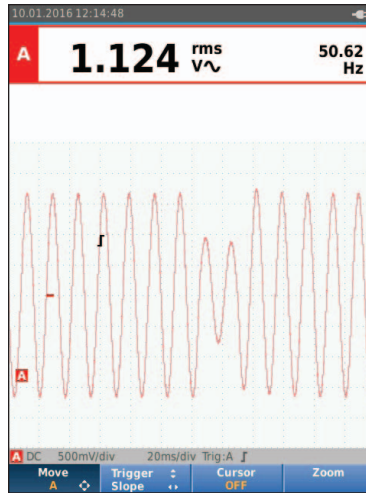
트리거 지점은 한 지점으로 설정되지만 두 번째 기간의 리딩 에지 착오로 인해 추가 트리거가 발생하여 불안정하게 표시됩니다.
