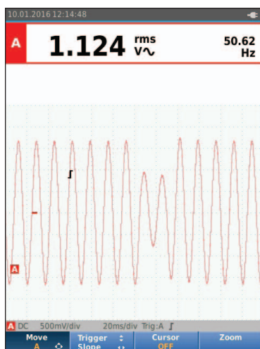
Điểm kích hoạt được thiết lập đến một điểm nhưng do quang sai trên sườn trước trong giai đoạn thứ hai, một kích hoạt bổ sung dẫn đến một màn hình hiển thị không ổn định.
