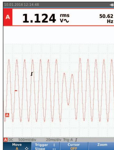
O ponto de trigger é ajustado para um ponto mas devido à anormalidade na borda de ataque no segundo período, um trigger adicional resulta em uma exibição instável.
