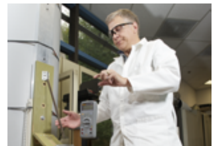
낙하 테스트. Fluke 179와 같이 -10 ~ 50°C로 지정된 미터는 -10°C일 때, 그리고 50°C일 때 다시 1m 높이에서 6면이 각각 바닥에 당도록 떨어뜨립니다.
