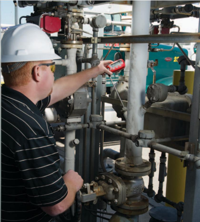
Nem sempre é possível ou prático remover instrumentos de um processo de calibração. A verificação in situ em um único ponto pode ser a única maneira de saber se um instrumento está funcionando conforme o esperado. Um único ponto de verificação é mais eficaz através de uma gama de temperatura estreita e quando combinado com outras tendências e informações relacionadas ao processo e equipamentos. Ele também exige que o processo não esteja em um estado dinâmico de mudança.
