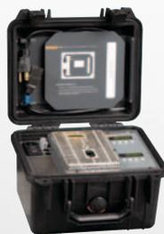
Calibrador de Termômetro Industrial Dual-Block 9009
