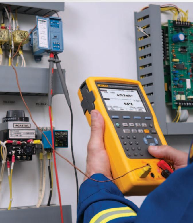
Transmissores inteligentes de temperatura, com sua flexibilidade e precisão melhoradas, tornaram-se as melhores ferramentas de trabalho na calibração de temperatura para os profissionais de instrumentação.
