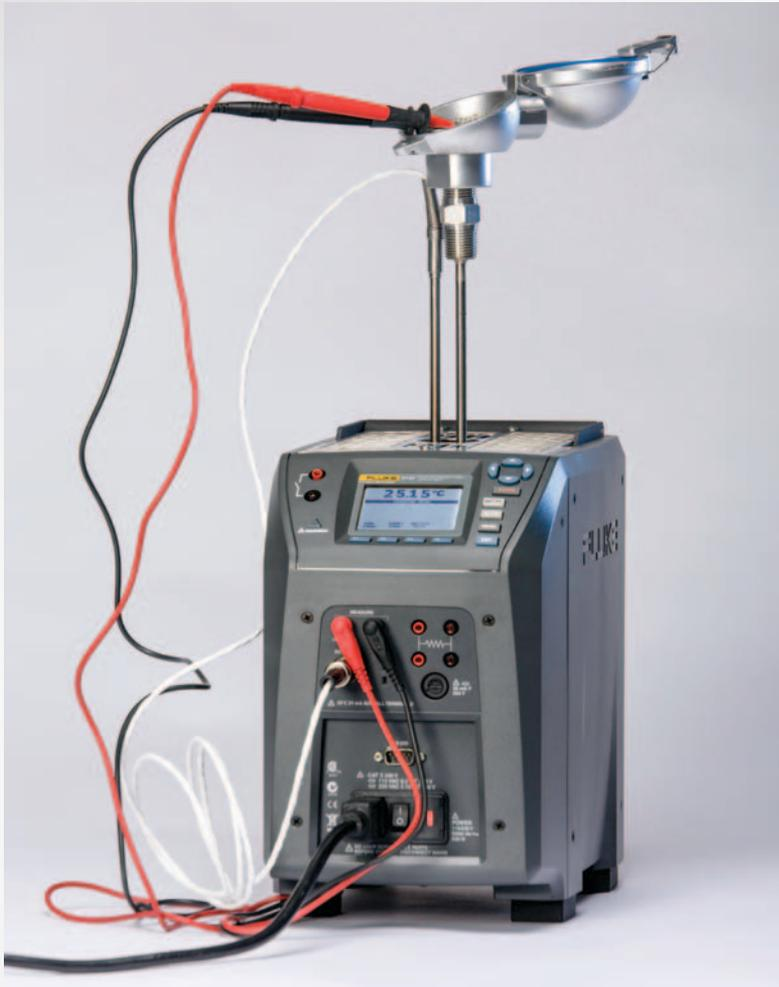
Nas indústrias de processos industriais, equipamentos de medição de temperatura geralmente têm dois componentes: um dispositivo de detecção, como um RTD ou termopar e um transmissor para ler e retransmitir o sinal para o sistema de controle.
