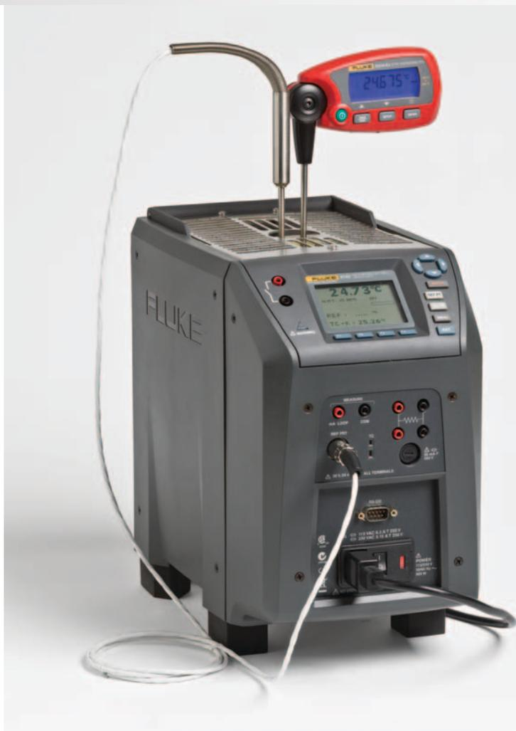
Normalmente os RTDs são verificados durante a calibração do dispositivo conectado, como um medidor de painel ou um transmissor de temperatura. No entanto, se houver suspeita de um problema com um sensor de temperatura, calibrações de sensor podem ser realizadas separadamente da calibração de componentes eletrônicos do processo.
