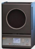
Calibrador de Precisão de Infravermelhos 4181
