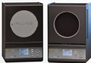
Os Calibradores de Precisão de infravermelhos 4180 e 4181 da Fluke Calibration oferecem calibrações mais consistentes, precisas e confiáveis porque a emissividade é radiometricamente
