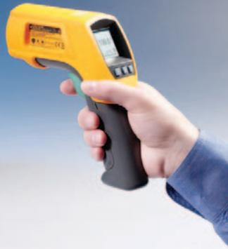
Calibrações de termômetro de infravermelhos podem ser precisas com configurações e planejamento corretos. É importante escolher um calibrador com um alvo radiometricamente calibrado que é grande o suficiente para acomodar a distância de calibração recomendada de termômetros de infravermelhos comuns, juntamente com os seus vários campos de visão.
