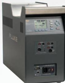
O Bloco de Metrologia de Campo UltraFrio 9190A da Fluke Calibration é o bloco seco de temperatura fria mais preciso e estável do mercado. É ideal para aplicações que exigem rigoroso controle de qualidade e conformidade de regulamentação de processos. Estas aplicações incluem validação e calibração no local de RTDs, termopares,
