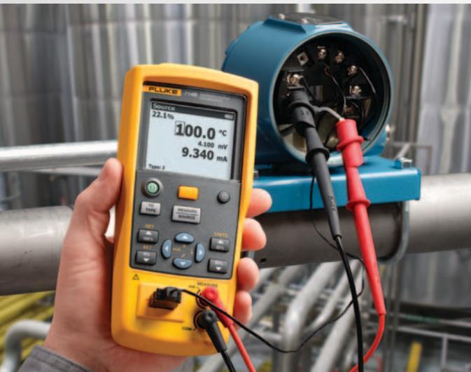
Termopares e RTDs são os sensores mais comuns utilizados em medições de temperatura de processos.
