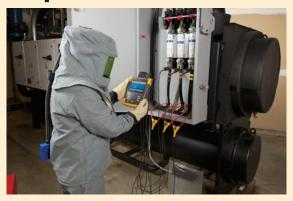
Basta ligar os cabos de medição de tensão e as sondas de corrente flexíveis ao serviço que alimenta o motor.
