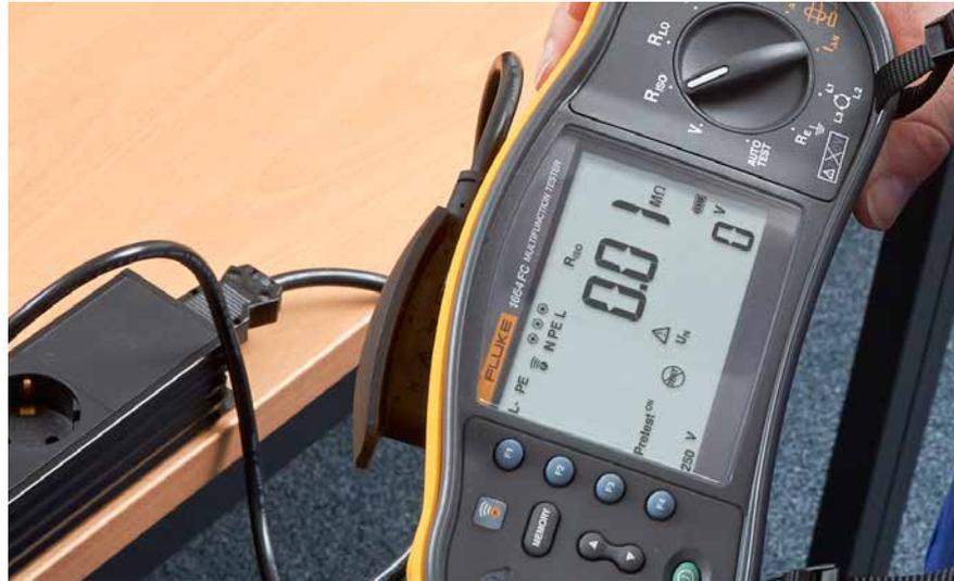
Si le testeur détecte qu'un appareil est connecté, il arrête le test d'isolement et donne un avertissement visuel. Cela permet d'éliminer les dommages accidentels de l'équipement périphérique et garantit la satisfaction des clients.
