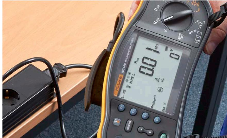
Wenn der Tester erkennt, dass ein elektrisches Gerät angeschlossen ist, bricht er die Isolationsprüfung ab und zeigt eine Warnung auf dem Bildschirm an. Damit können versehentliche Beschädigungen an Peripherieausrüstung beseitigt werden, und Ihre Kunden sind glücklich.
