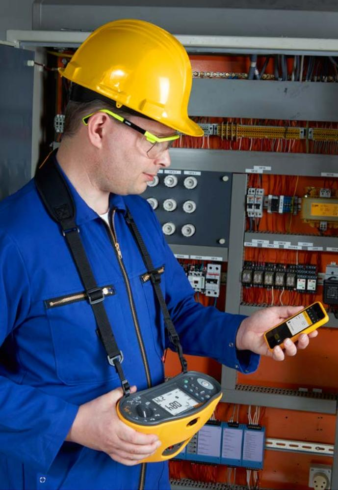
합니다. 자동 테스트 주기가 완료될 때까지 x5 RCD의 정격 전류를 사용하여 시퀀스가 반복됩니다. 계측기는 RCD가 수동으로 재설정된 시기를 '감지'하고 시퀀스의 다음 테스트를 시작합니다. 결과가 임시 메모리에 저장되고 화살표 버튼을 사용하여 단계별로 결과를 확인할 수 있습니다. 1663 및 1664 FC에는 나중에 재호출하거나 DMS 소프트웨어를 사용하여 생성한 보고서로 가져오기 위해 결과를 저장할 수 있는 내부 메모리도 있습니다.
