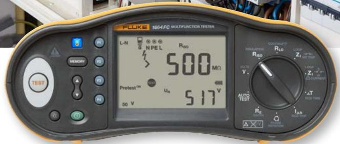
는 배전반에서 수행하거나 계측기와 함께 제공되는 전원 코드가 연결된 콘센트에서 수행할 수 있습니다. 배전반에서 연결하는 경우 RCD 부하면의 편리한 지점에 회선, 중성 및 접지 도체를 연결합니다. 테스트는 부하가 단전된 라이브 회로를 사용하여 수행됩니다. 1660 시리즈 테스터는 사전 테스트도 수행하여 실제 테스트에서 50V 또는 25V 제한을 초과하는 결함 전압을 생성하는지 판별합니다. S 유형(시간 지연) RCD의 경우 1660 장치를 S 유형 모드로 설정합니다. 이 모드는 부정확한 작동 시간을 피하기 위해 사전 테스트와 실제 테스트 사이에 활성화되는 30초의 지연 시간을 포함시킵니다.
