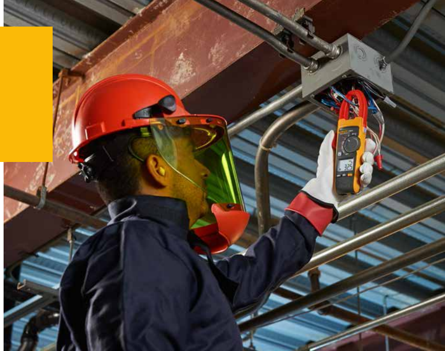
작업하는 전기 환경을 충족하는 등급뿐만 아니라 테스트에 필요한 측정 분해능과 정확도를 갖춘 클램프 미터를 선택하십시오.
