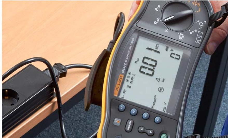
Apabila tester mendeteksi bahwa peralatan terhubung, alat ini akan menghentikan pengujian insulasi dan memberikan peringatan visual. Hal ini membantu menghindari kerusakan yang tidak disengaja pada perlengkapan yang ada di sekitarnya dan memberi kepuasan pada pelanggan Anda.
