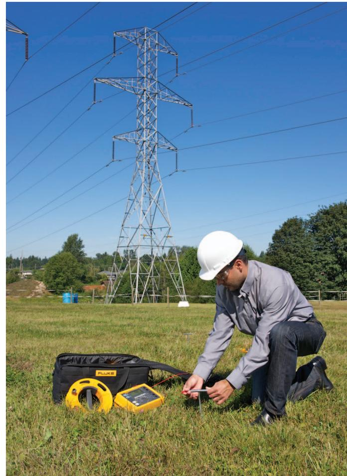
de potencial de 3 polos, duas estacas de aterramento são colocadas no solo, em linha reta e afastadas do eletrodo de aterramento.
