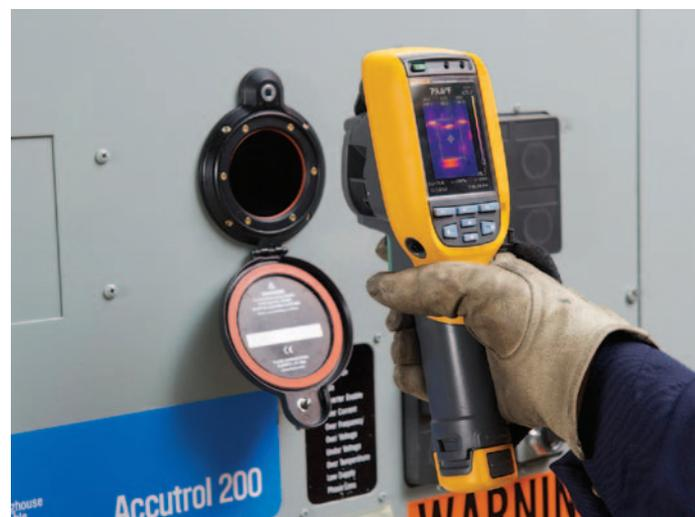
Figura 3. O uso da janela de IR para executar uma inspeção térmica no equipamento aumenta consideravelmente a segurança do técnico na visualização térmica. As exposições a choques e descargas em arco são reduzidas a praticamente zero.
