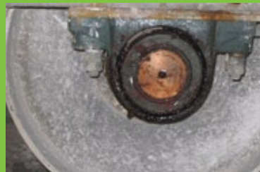
Этот перегрев вала и подшипника может указывать на выход подшипника из строя, отсутствие надлежащей смазки или на нарушение соосности.
