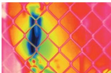
Пассивные системы часто настраиваются только на объекты в ближней зоне, в данном случае — сетку металлического ограждения.
