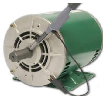
Messen der Wellenspannung an einem Motor mit einer Aegis-Wellenspannungssonde (Foto mit freundlicher Genehmigung von Electro Static Technology).
