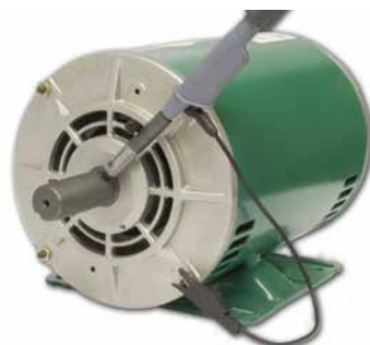
Medida de la tensión en el eje del motor con una sonda de tensión del eje Aegis (fotografía cortesía de Electro Static Technology).
