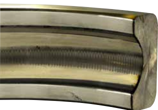
Estriado de la pista de rodamiento provocado por corriente en el rodamiento (fotografía cortesía de Electro Static Technology).
