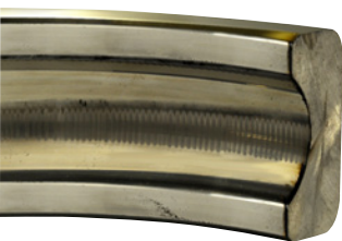
Scanalatura di una pista di cuscinetto causata dalle correnti dei cuscinetti (fotografia gentilmente concessa da Electro Static Technology).
