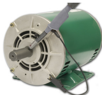
Misura della tensione dell'albero motore con una sonda di tensione dell'albero Aegis (fotografia gentilmente concessa da Electro Static Technology).
