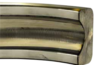
Groefvorming in een lagerloopvlak als gevolg van lagerstromen (foto met dank aan Electro Static Technology).
