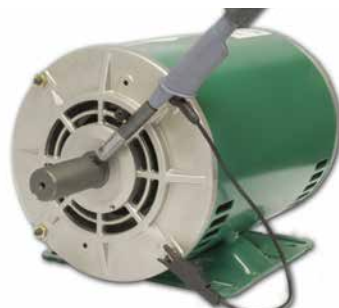
Metten van de motorasspanning met een Aegis-asspanningsprobe (foto met dank aan Electro Static Technology).
