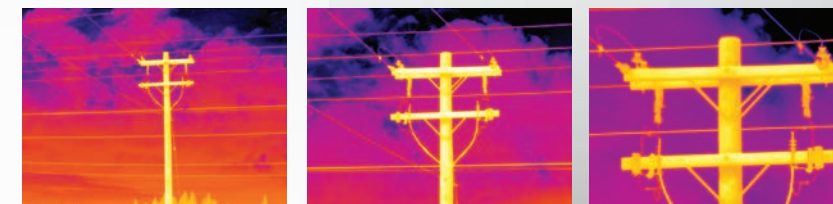
Standaard (links), 2x telelens (midden) en 4x telelens (rechts) – bekijk het juiste niveau aan kritische warmtebeeldetails
