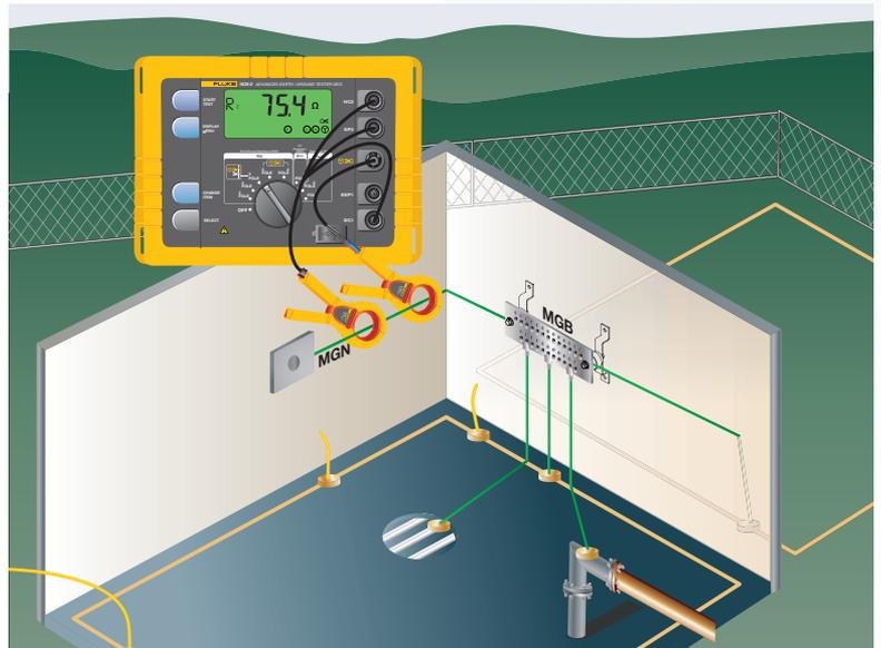
Gambar 1 : Pengujian stakeless kantor pusat.
