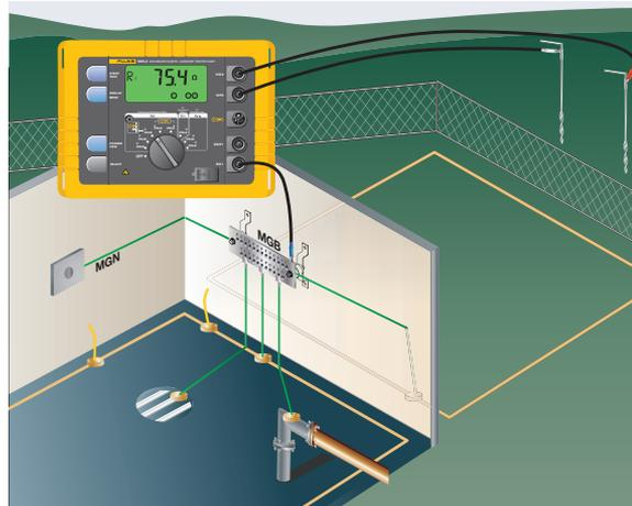
Gambar 2 : Lakukan tes Fall-of-Potential 3-Kutub dari seluruh sistem arde.
