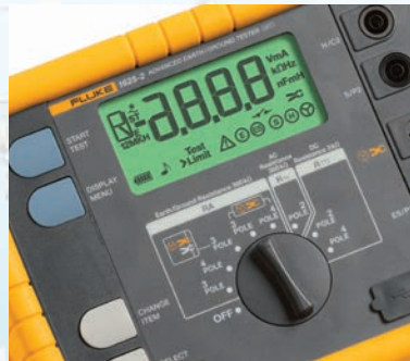
Fluke 1625-2 を使用して、接地システムの正常性を判別します。
