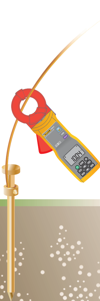
Fluke 1630-2 FC を使用したスターク レス方式によるテストのセットアップ
