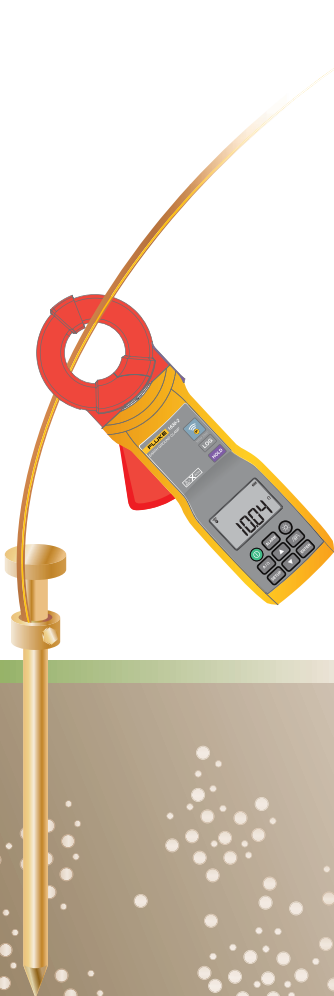
Opsætning til den spydløse metode ved hjælp af 1630-2 FC.
