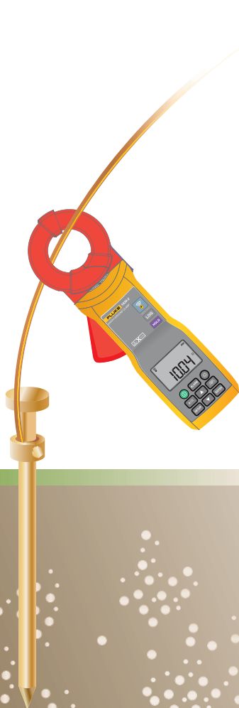
Preparação para o método sem estacas usando o 1630-2 FC.
