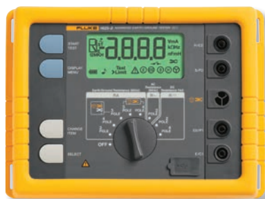
Testador avançado de aterramento GEO Fluke 1625-2
