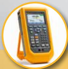
Beim Prüfen eines Druckschalters mit dem automatischen Druckkalibrator Fluke 729 werden Einstell- und Rückstellpunkte des Schalters sowie die Hysterese (Totzone) automatisch ermittelt und dokumentiert, wodurch Zeit gespart und zuverlässige, wiederholbare Ergebnisse erzielt werden.
